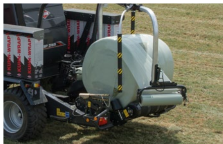
Daarna wordt het cilindrisch oppervlak van de baal gewikkeld tot ongeveer 80% bedekt is.
