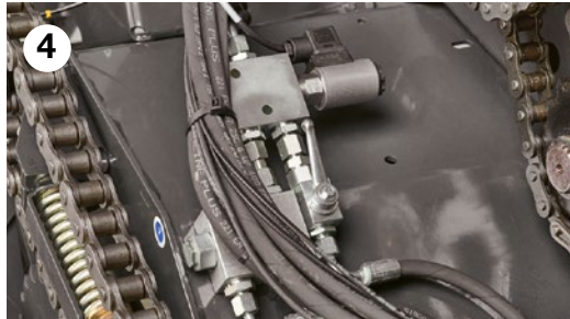
Aparte regeling messen / DROPFLOOR vanuit de bestuurdersstoel
