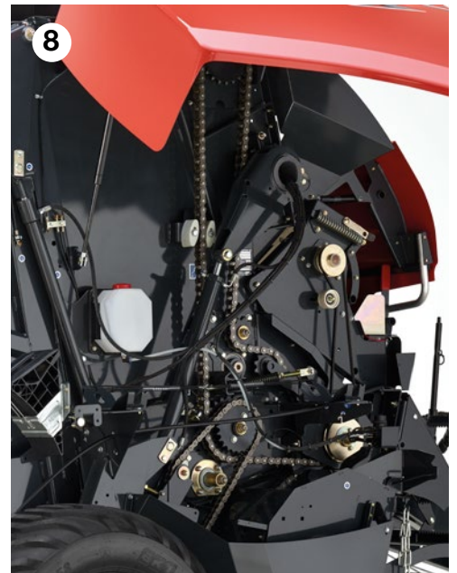
Robuust aandrijfsysteem met "IWIS"-kettingen van hoge kwaliteit + 1/4" 20BH hoofdaandrijving met hardverchroomde pennen
