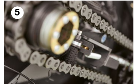
Solide en brede smeerborstels op de kettingen zorgen voor een perfecte smering.
